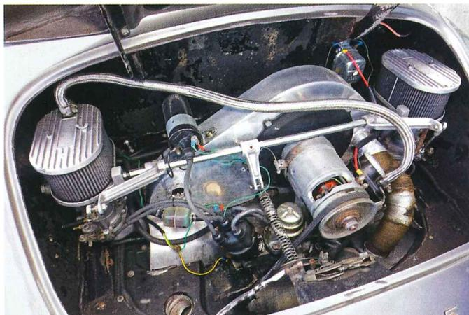
**Gavé par deux carburateurs Dell'Orto, le 1600 Volkswagen reste conforme à l'idée que l'on se fait d'un moteur de Cox. Flap-flap !**
